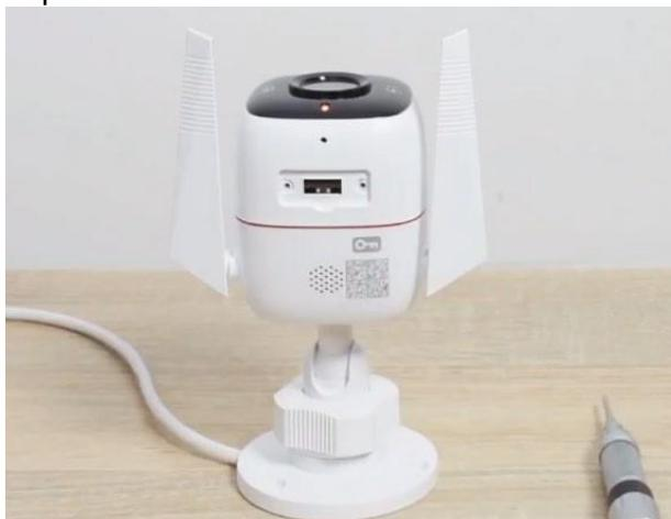
2. Pressione e segure o botão Reset por 5 segundos até que o LED pisque em vermelho para redefinir apenas as informações de Wi-Fi; Pressione e segure o botão Reset por pelo menos 10 segundos até que o LED pisque rapidamente em vermelho para redefinir sua câmera para as configurações padrão de fábrica.
